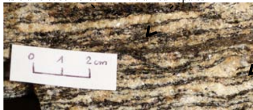
Métatexite : gneiss migmatitique oeilé, échantillonné dans les fondations du château de Limand (phot. H. Bonnot)
